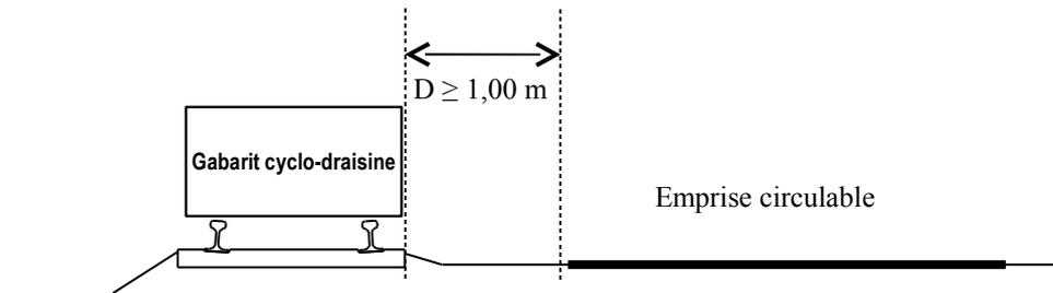
La superposition des emprises n'est envisageable qu'au droit d'ouvrages d'art dont la largeur ne permet pas d'assurer la continuité du profil en travers de la plate forme commune. Les tunnels en sont exclus. Cette section commune est admise sous les conditions suivantes :
