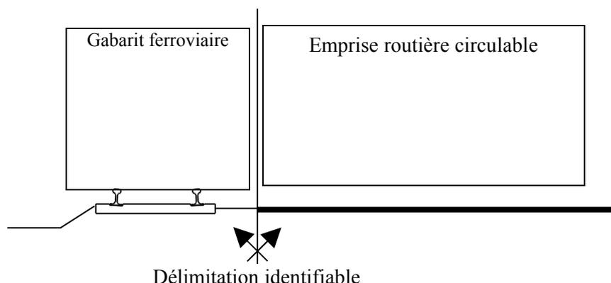
En outre, un espace de sécurité, doté ou non d'un séparateur physique est, selon les cas, réservé entre les deux emprises, pour limiter le risque de pénétration des véhicules routiers dans le gabarit ferroviaire.
