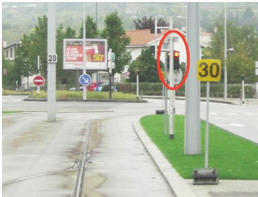
*Support implanté en amont du signal R17 et altérant la visibilité sur celui-ci*
