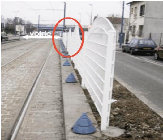
*Mauvaise visibilité sur l'interruption de la barrière et donc sur les piétons susceptibles de traverser la plate-forme*
