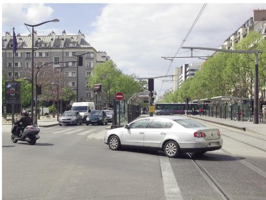
*Mobilier de station masquant la visibilité aux véhicules tournant à gauche*
