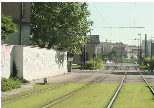
*Le mur proche de la plate-forme et de la chaussée empêche de voir si un véhicule est arrêté en retrait du signal R24 et de la barrière mobile*
