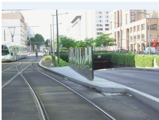
*Dispositif anti-éblouissement entre la plate-forme tramway et la chaussée*
