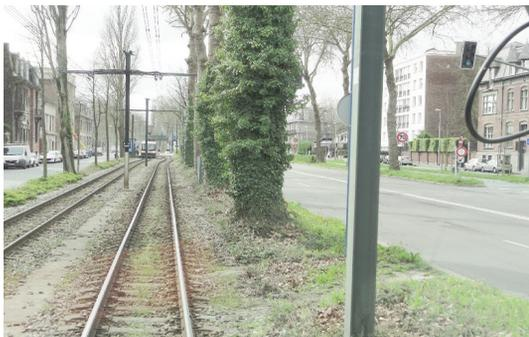
Alignement végétal nuisant à la visibilité du conducteur de tramway sur d'éventuelles traversées « sauvages » de la plate-forme par des piétons
