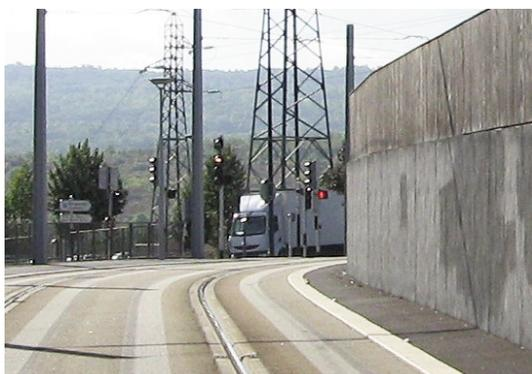
*Mur de soutènement masquant la signalisation implantée dans la courbe*
