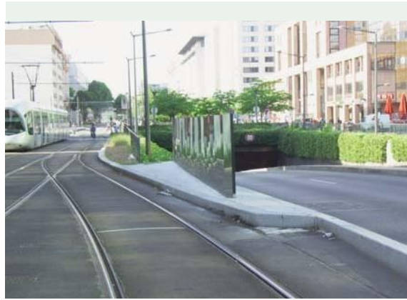
有轨电车与车行道之间的反目眩装置
