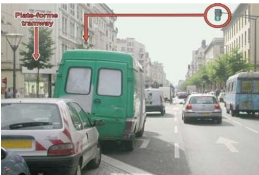
用户横穿有轨电车道之前，左转交通灯（不同于直行信号装置）被停在通行道路上的货车遮蔽
