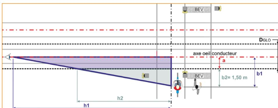
Schéma 12 : Cône de visibilité pour une traversée cycle contiguë à une traversée piétonne gérée par signalisation lumineuse
