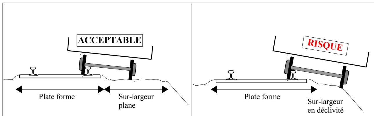
Plate-forme avec sur-largeur plane
