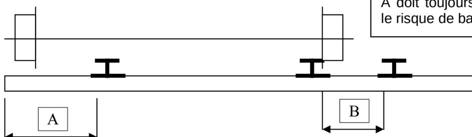
A doit toujours être supérieur à B pour éviter le risque de basculement.
