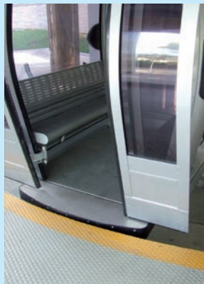
Barcelone : faible lacune entre le quai et la cabine – Crédit photo : CETE de Lyon
