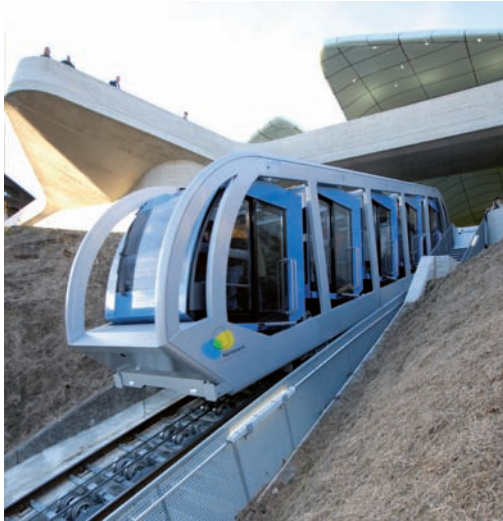
Funiculaire d'Innsbruck (Autriche) – Crédit photo : IARM Longueur de 1830 m, dénivelé de 288 m, vitesse de 10 m/s pour une capacité de 1200 personnes par heure et par sens
