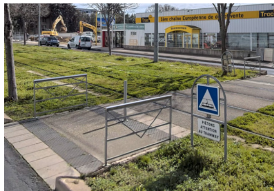
Le panneau C20c et le panneau peuvent être associés ou utilisés indépendamment l'un de l'autre (Montpellier, ©Plans)
