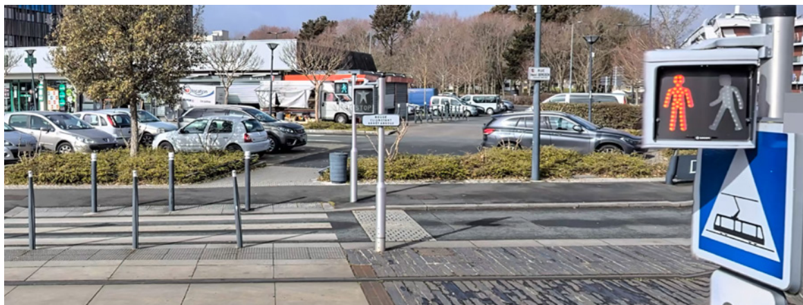
Traversée en plusieurs temps : les signalisations lumineuses des voies routières et de la plateforme sont dissociées, avec recours au R25 dans cet exemple (Angers, ©Plans)
