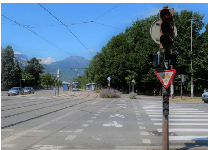
Exemple d'implantation d'un panonceau M12 permettant un mouvement compatible avec la phase tramway. (Source : Cerema)
