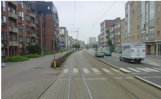
Photo 2 : séparation végétal dont la hauteur ne compromet pas la visibilité en amont de la traversée piétons/cycles.
