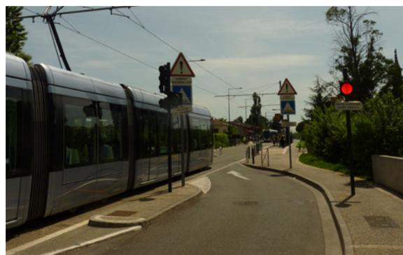
Ilustración 13: Entrada de la plataforma compartida regulada por semáforo R24 en Toulouse
