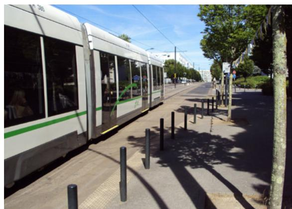
Ilustración 21: Bolardos que limitan el estacionamiento en Nantes
