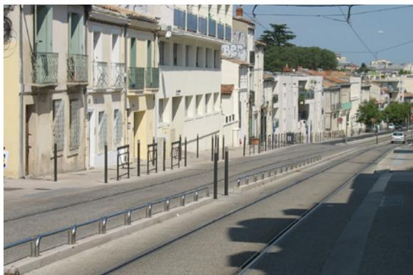
Ilustración 3: Separadores antes de una estación con andenes decalados en Montpellier
