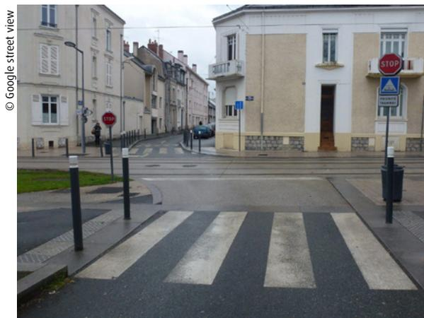
Ilustración 32: Cruce en plataforma compartida regulado por stop en Angers
