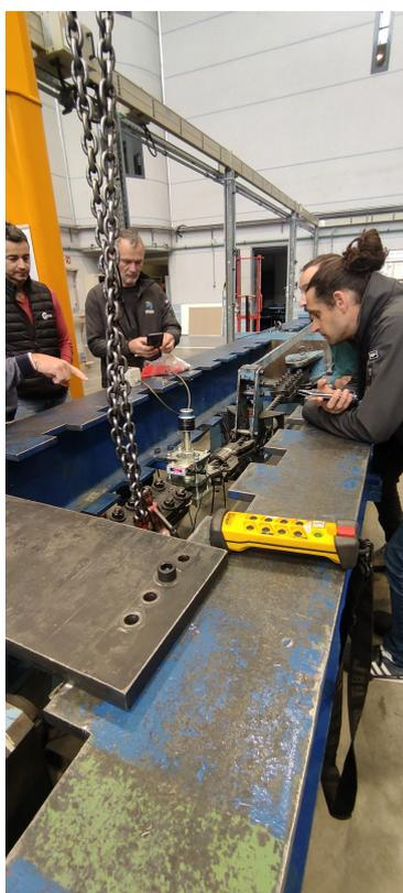
FIGURE 65 – Photo du banc d'essai de la caractérisation de frottement pour une attache de câble
