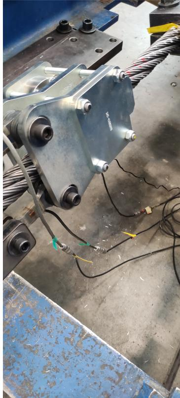
FIGURE 66 – Photo de l'échantillon de l'essai de caractérisation de frottement
