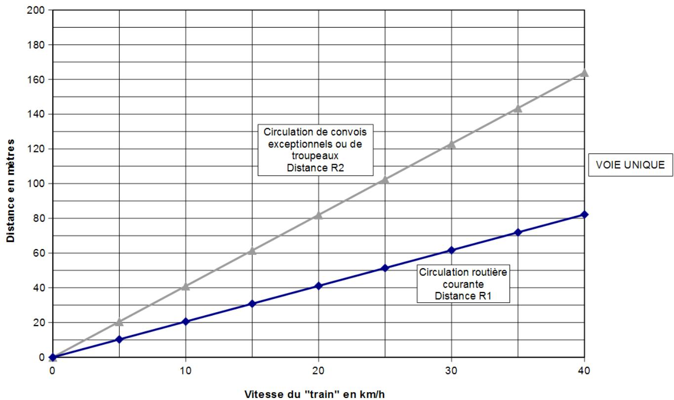
Exemple : Pour une voie ferrée circulée à 20 km/h, si à une distance comprise entre 3.5 et 5 m du rail, le train est visible à 40 m de part et d'autre du PN, alors la condition statique b) est satisfaite.
