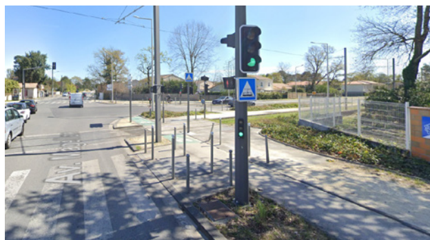
Exemple de superposition de grillage rigide perpendiculaire non acceptable.
